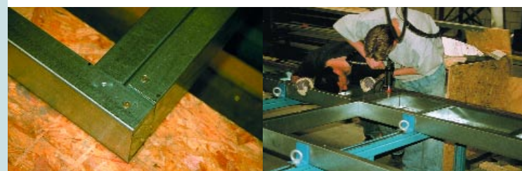
afb. 5.14 Het uiterlijk van een clinchverbinding.
